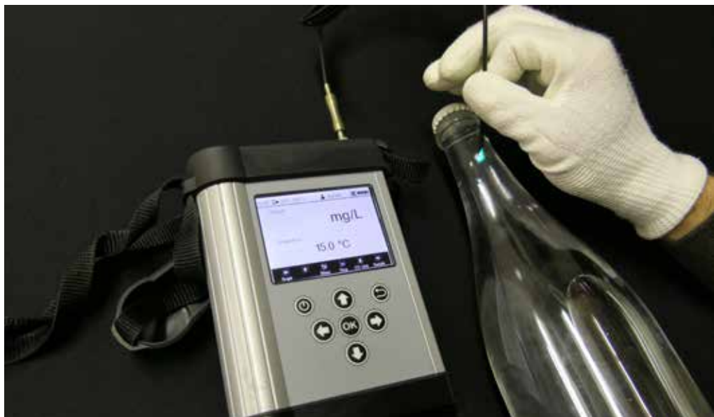
Figure 3. Mesure de l'oxygène dissous par chimiluminescence (NomaSense™).
