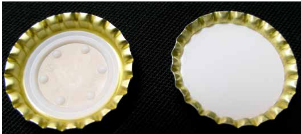
Figure 2. Le joint synthétique est de type coulé-moulé (à gauche) ou rapporté (à droite).
